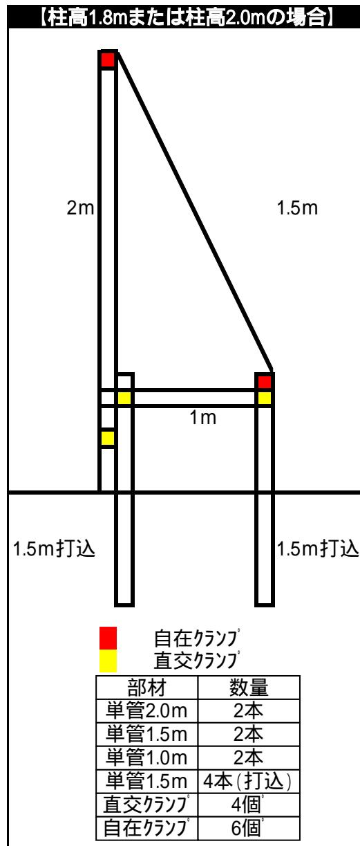
2. 下図のように単管とクランプでゲートを取り付ける支柱を準備します。
