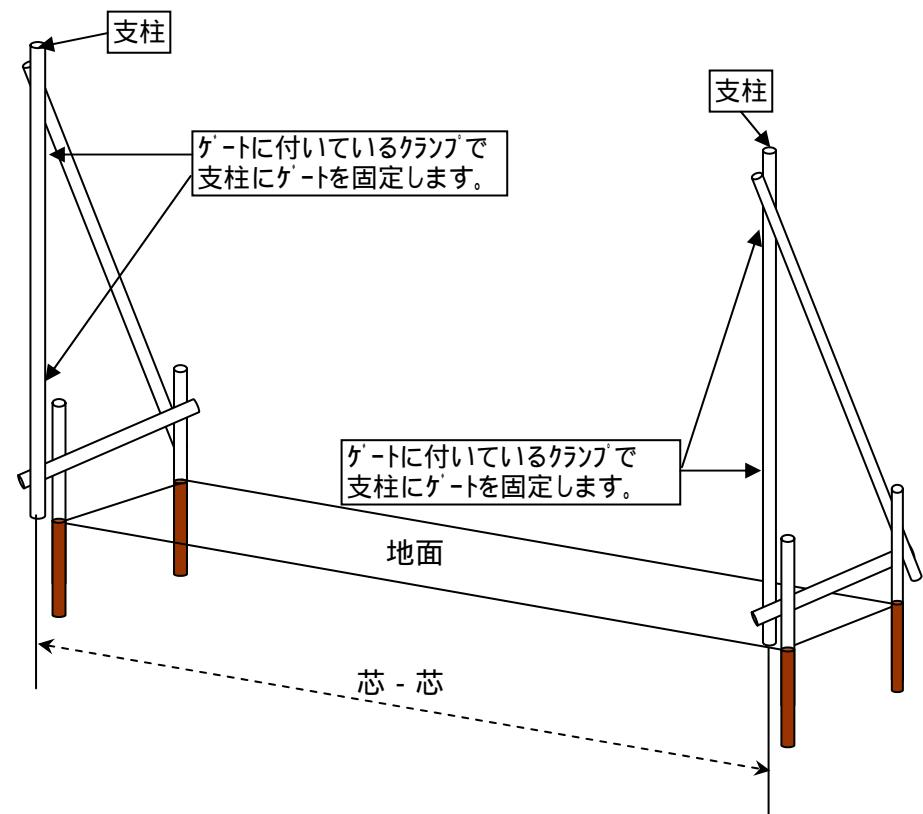
3. 支柱の準備ができたらゲートに付いているクランプで支柱に固定します。
